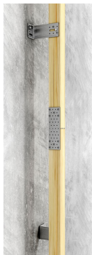
Fijación cabrios madera por la escuadra ABC y empalme de los cabrios por placas perforadas NP
