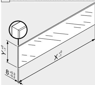
En combinación con LEGRABOX | TANDEMBOX basándose en las dimensiones predeterminadas no se requiere una "prueba de impacto para componentes de vidrio verticales." según la normativa (DIN EN 14749 de junio de 2016). Para el cumplimiento de la normativa no es necesario un cristal de seguridad.
