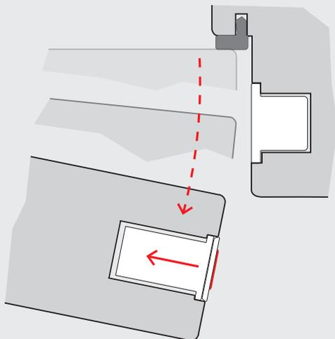
Con la puerta abierta, los imanes vuelven al ras del frontal, lo que permite un diseño limpio y evita los problemas derivados de los salientes.
